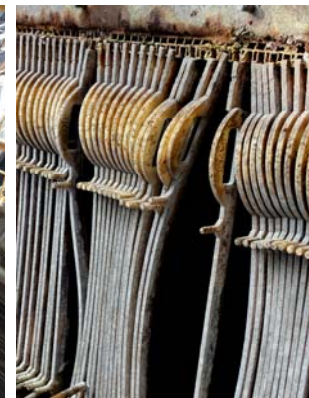
↑ 台灣康牌膜板沾黏污泥相互擠壓報廢, 以本公司膜板替換: 國瑞車廠
