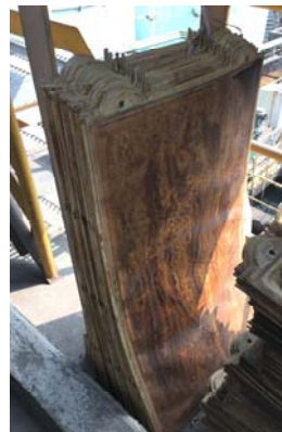
↑ 台灣康牌膜板沾黏污泥相互擠壓報廢, 以本公司膜板替換: 國瑞車廠
